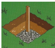
2. Rozprestrenie tenkej vrstvy štrku
